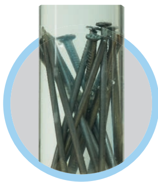
Образцы стали в антикоррозийной котловой воде Wäirme Hydro
