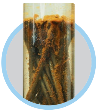
Образцы стали в питьевой воде или в воде из скважины
